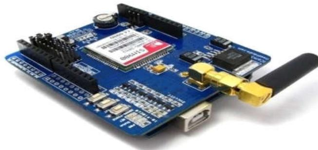
**Fig. 2 GSM Module**
